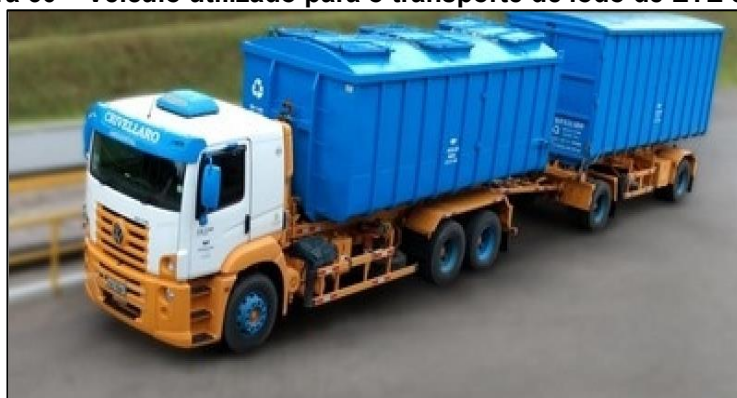
Figura 60 – Veículo utilizado para o transporte de lodo de ETE e ETA.
