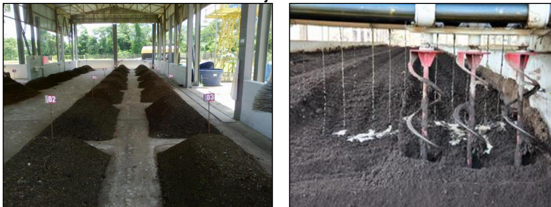
Figura 53 – Compostagem aeróbia de resíduos orgânicos em leiras. Compostagem mecânica de dejetos suínos.
