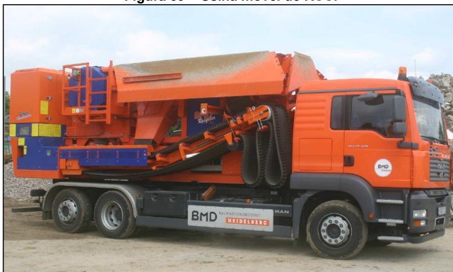
Figura 59 – Usina móvel de RCC.
