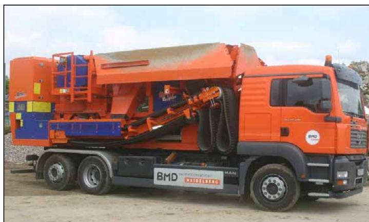
Figura 74 – Usina móvel de RCC.
