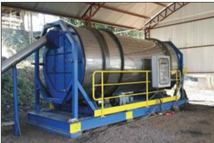
Figura 70 – Reator de compostagem acelerada.
