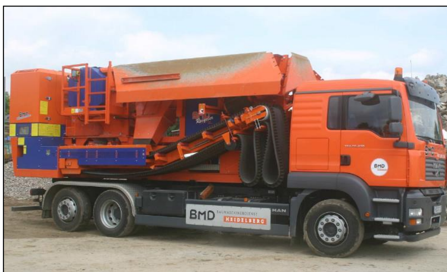
Figura 74 – Usina móvel de RCC.
