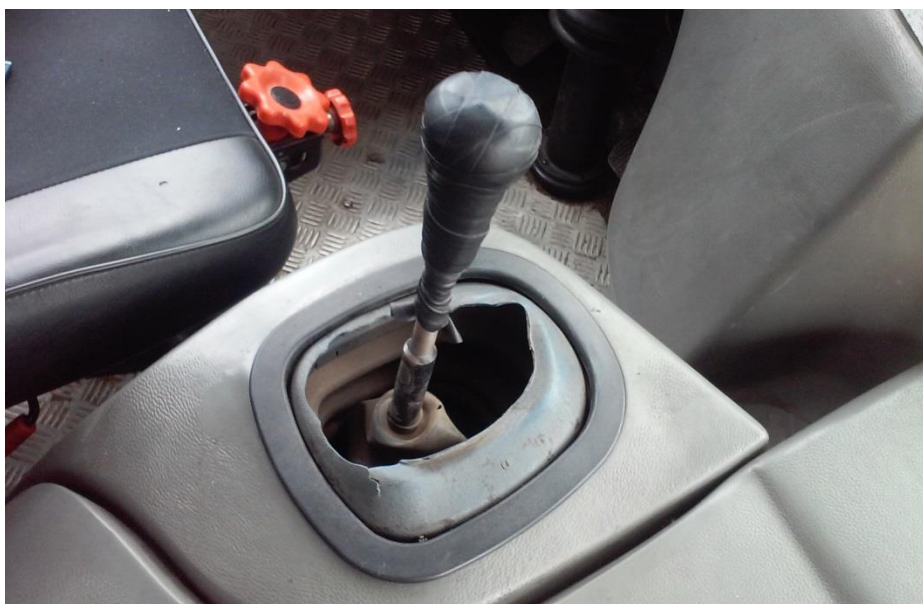
Foto 2 - Alavanca de câmbio danificada e remendada com fita isolante
