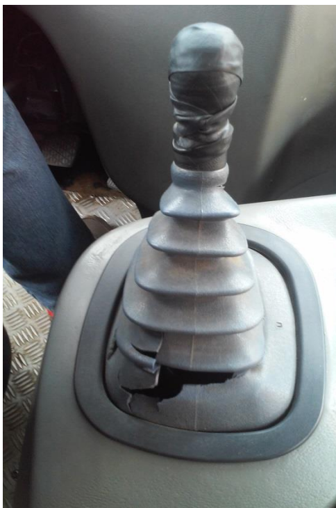
Foto 6 - Alavanca de câmbio danificada e remendada com fita isolante
