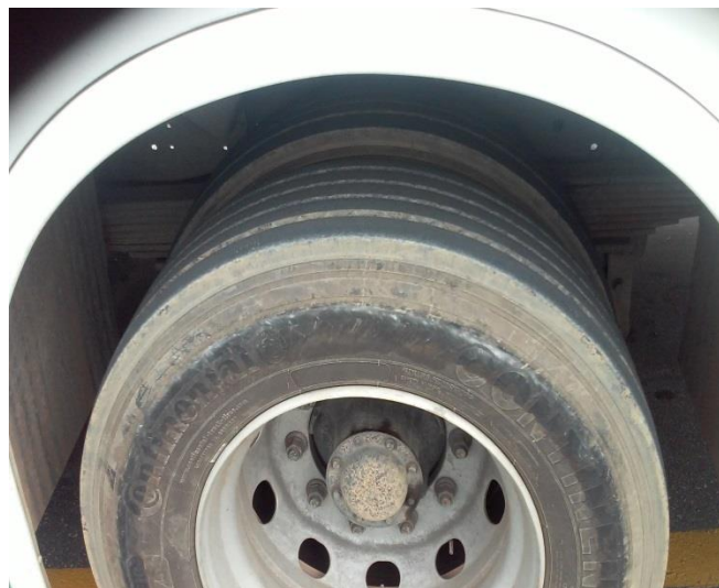
Fotos 7, 8 – Pneus completamente desgastados (carecas)
