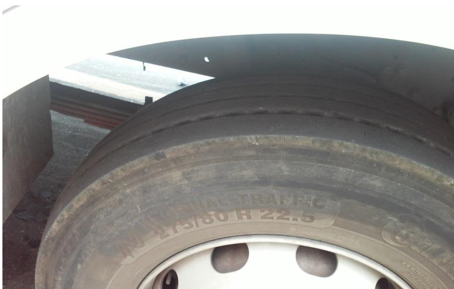
Foto 3 – Pneus completamente desgastados
