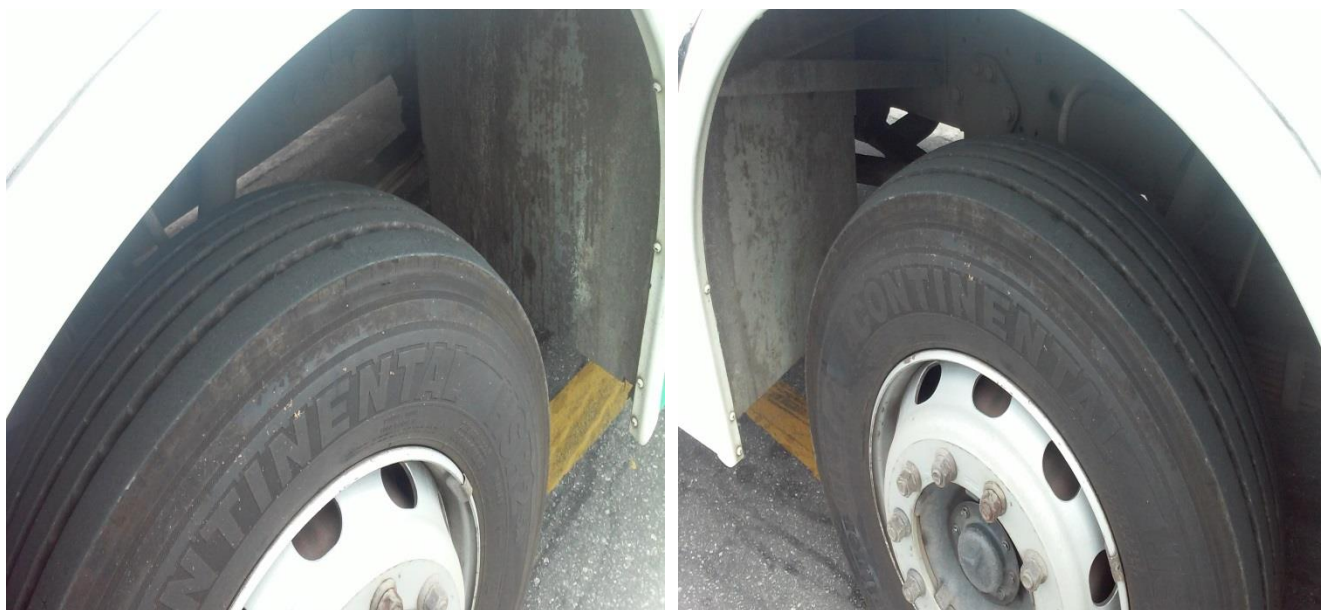
Fotos 10, 11 – Pneus completamente desgastados (carecas)
