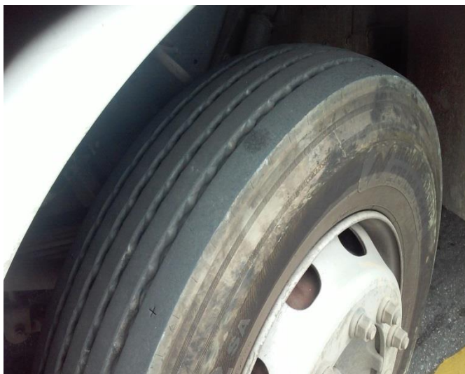
Fotos 7, 8 – Pneus completamente desgastados (carecas)
