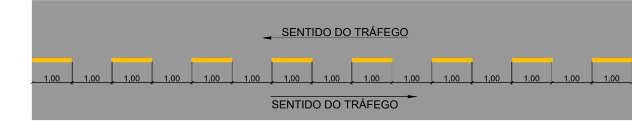
DET.02 LINHA DE CONTINUIDADE - TRACEJADA (LCO) 1X1 COR AMARELA ESCALA 1:100
