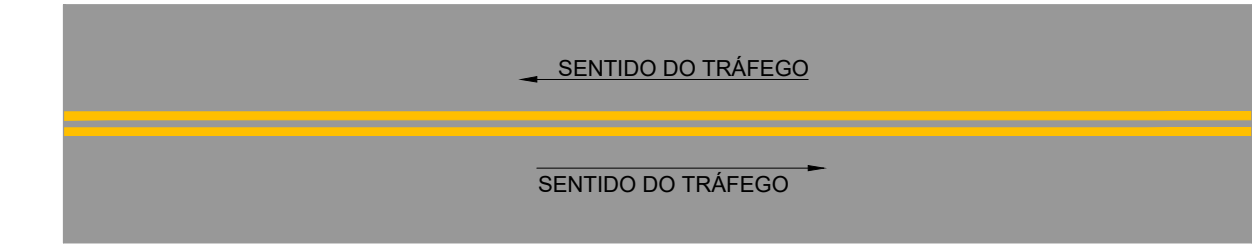
DET.02 LINHA DE CONTINUIDADE - TRACEJADA (LCO) 1X1 COR AMARELA ESCALA 1:100
