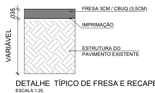
DETALHE TÍPICO DE FRESA E RECAPE ESCALA 1:25
